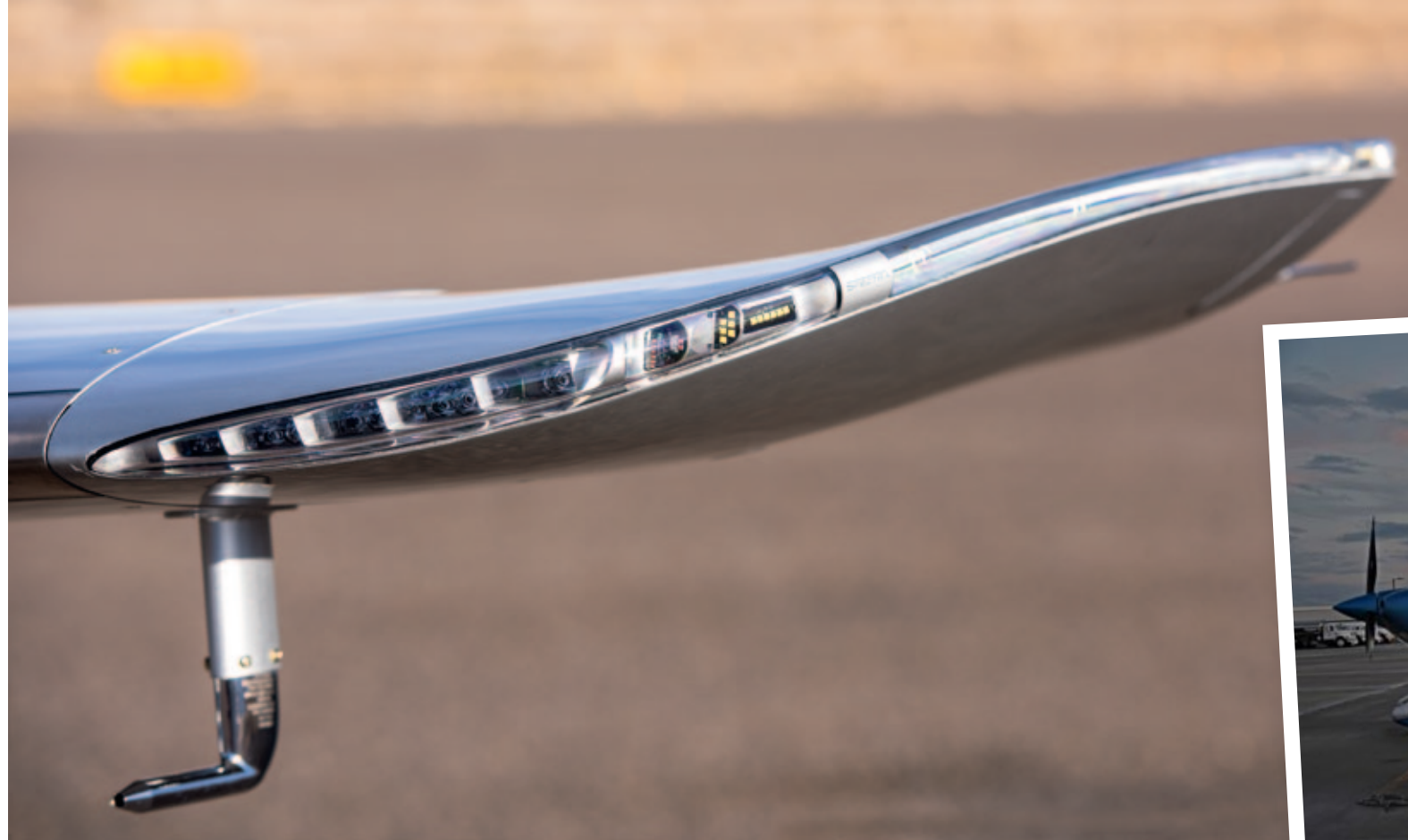
Alles LED: Strobes, Positions- und Landelichter sowie der Leuchtstreifen am Randbogen sind Teil der neuen Spectra Wingtips
