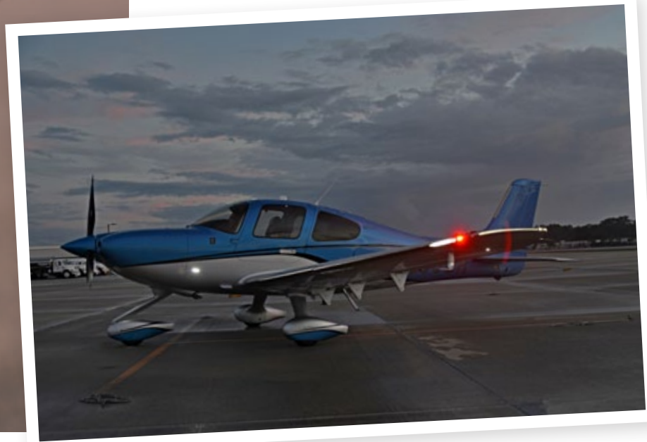
Alles LED: Strobes, Positions- und Landelichter sowie der Leuchtstreifen am Randbogen sind Teil der neuen Spectra Wingtips
