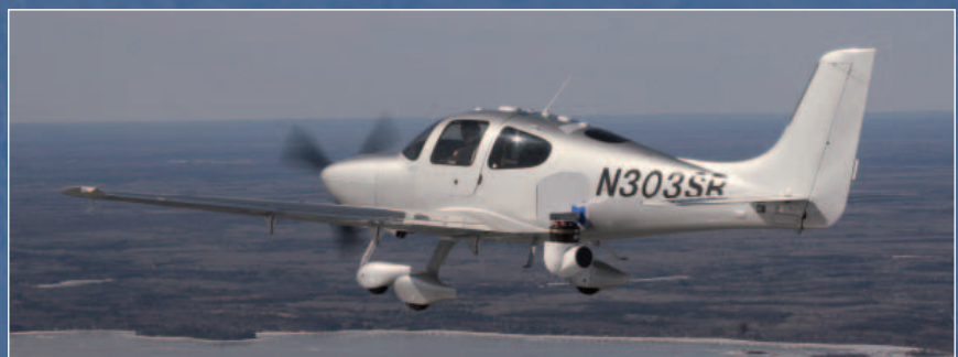
■ Pohled do zavazadlového prostoru s potřebnou elektronikou, vpravo letový záběr ze zkoušek funkčnosti zavěšení snímací hlavice
