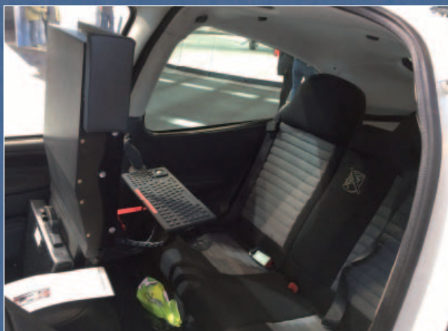
■ Umístění pracoviště operátora na pravém zadním místě dává dostatek prostoru pro instalaci obrazovek a ovládacích prvků
