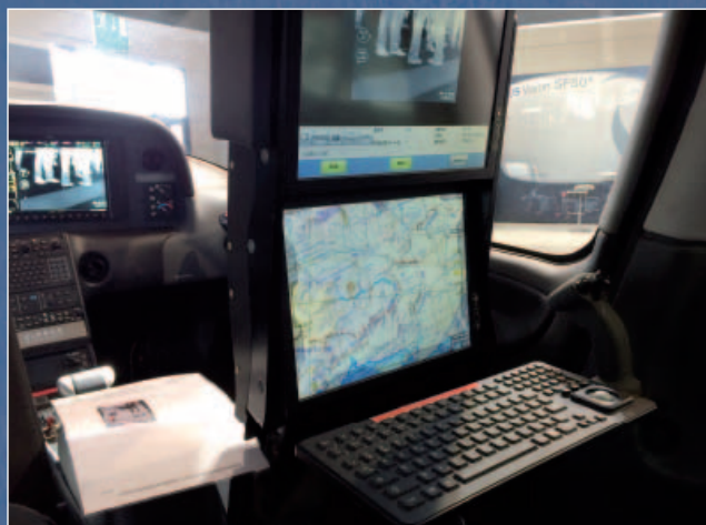
■ Umístění pracoviště operátora na pravém zadním místě dává dostatek prostoru pro instalaci obrazovek a ovládacích prvků
