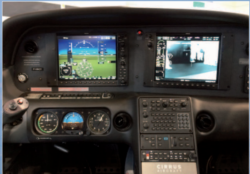
■ Pilot si může na pravém displeji pustit výstup z kamery a snáze tak koordinovat činnost s operátorem
