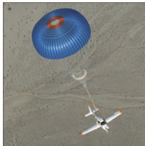
Plně rozvinutý padákový záchranný systém
