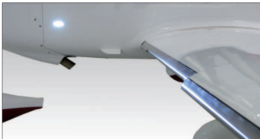
Křídlo letadla Cirrus s viditelně oddělenou náběžnou hranou navrženou na odolnost k pádu do vývrtky. U trupu je viditelná trhací lišta pro včasné varování
