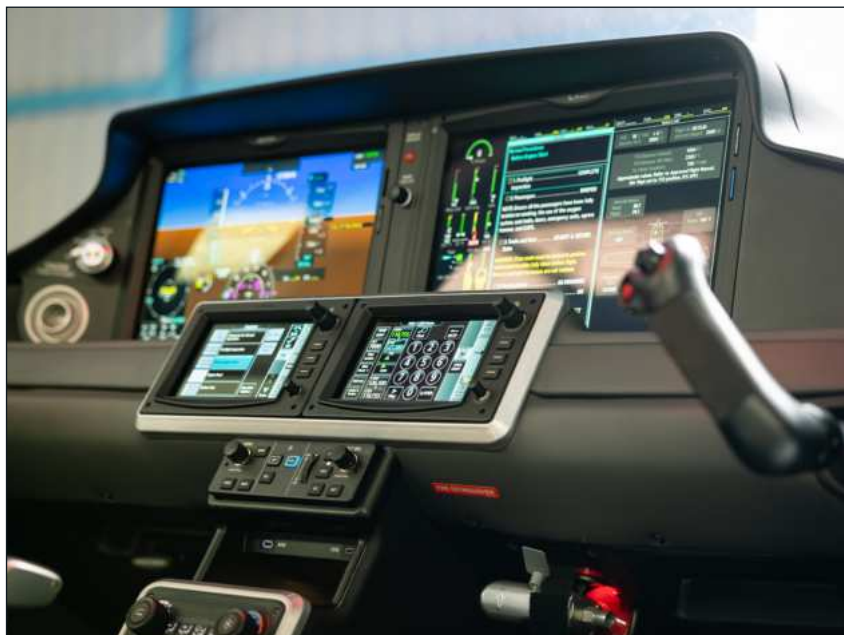
Sedmá generace Cirrusu řady SR s glass cockpitem Garmin Perspective Touch+ s dvěma 14palcovými displeji rozdělitelnými do dvou až tří oken s dvěma ovládacími dotykovými obrazovkami je převzatá z proudového Cirrus Jetu
