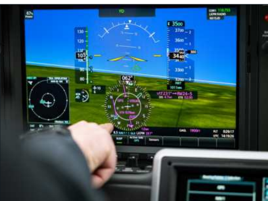
Na primárním displeji je nyní možnost navolit si funkci GLD, směrník ukazující směr a vzdálenost k nejbližšímu letišti na dokluzu pro případ vysazení motoru
