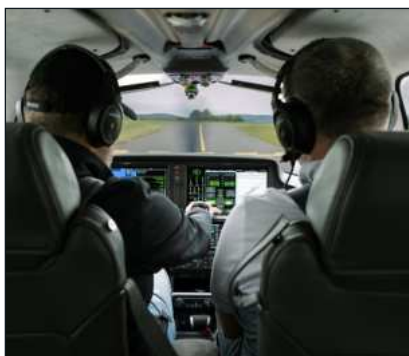
Sedmá generace Cirrusu řady SR s glass cockpitem Garmin Perspective Touch+ s dvěma 14palcovými displeji rozdělitelnými do dvou až tří oken s dvěma ovládacími dotykovými obrazovkami je převzatá z proudového Cirrus Jetu
