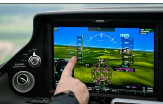
Garmin Prespective Touch + nyní automaticky zobrazuje vzdálenost k prahu dráhy pro včasné bezpečné vyklesání a zlepšení situačního povědomí při přiblížení
