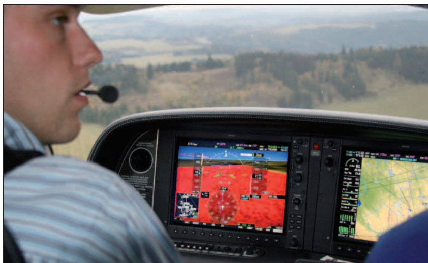
Syntetické vidění Garminu Perspective s GPS 3D terénem varující zčervenáním, když je terén 100 ft pod letadlem, doplňující zvukovým varováním „Terrain, Terrain“
