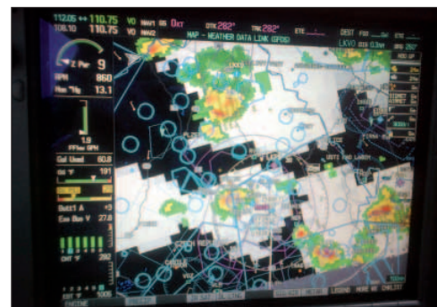
Počasí stažené za pomoci datalinku IRIDIUM, zobrazuje srážky, blesky, oblačnost, vítr v hladinách a oblast s vydaným varováním na počasí (SIGMET)
